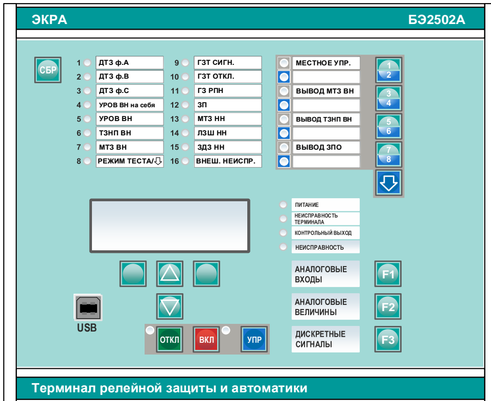
Рисунок 6.2 - Расположение элементов на лицевой панели терминала БЭ2502А1803
